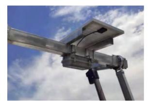
控制器输入电源为直流DC24V/交流AC220V,输出端连24V直流电机,直流电机内置在线性电动推杆,电动推杆长度变化调整实现支架角度变化,控制器和电动推杆一体化集成,推杆与控制器具备优异的匹配性,跟踪支架驱动系统寿命得以提升。
